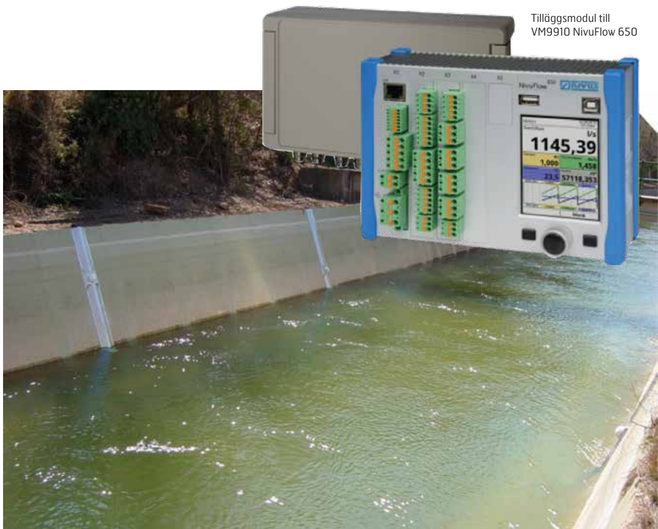
Typisk NivuFlow 650 applikation i öppen kanal.
